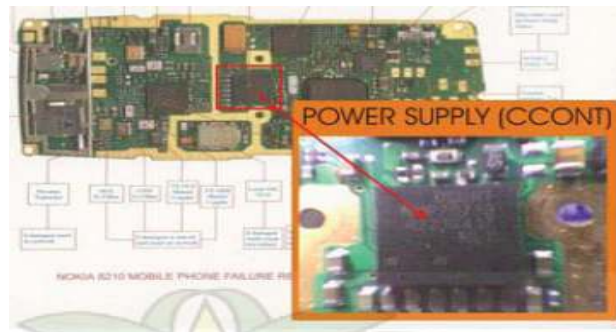
Gambar Power supply terpasang pada Nokia 8210
