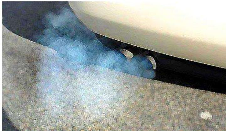
Ini merupakan tanda-tanda bahwa ada oli yang ikut terbakar di dalam silinder mesin. Beberapa kemungkinan penyebabnya antara lain : keausan pada Valve guide dan seal Valve yang mengeras, keausan dan kerusakan pada ring piston, keausan dan kerusakan pada dinding silinder.
