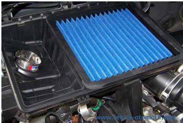
Pada filter atau saringan udara yang terbuat dari bahan kertas, maka filter udara tersebut dapat dibersihkan dengan cara menyemprotkan udara bertekanan dari arah dalam (dari arah keluarnya udara).
