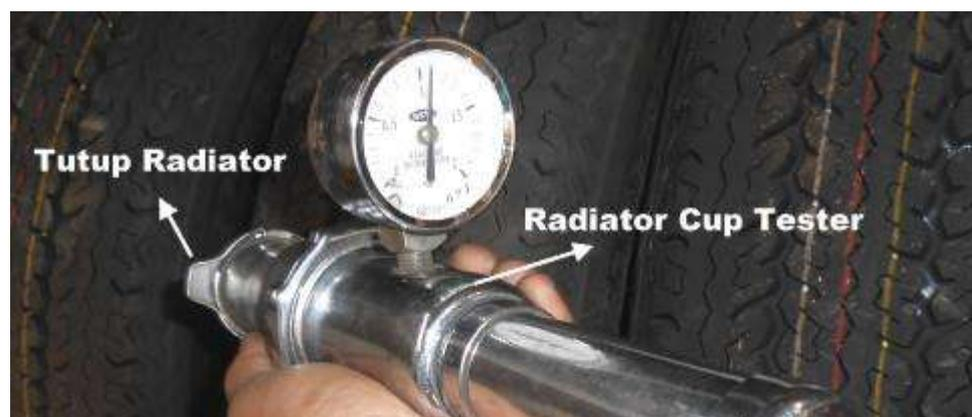
Pemeriksaan tutup radiator bisa juga di lakukan dengan menggunakan radiator cup tester untuk mengetahui tekanan relief valve radiator mulai terbuka, jika tidak sesuai dengan yang tertera pada tutup radiator lebih baik segera ganti tutup radiator.
