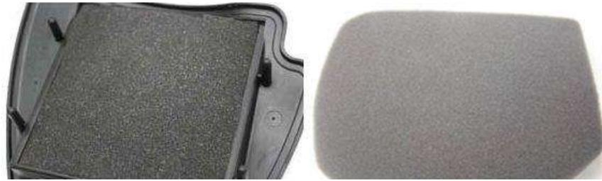
Filter atau saringan udara yang terbuat dari bahan spon atau busa dapat dibersihkan dengan cara mencucinya menggunakan air dan deterjen atau juga dapat dicuci dengan cairan pembersih lainnya. Setelah filter dicuci maka keringkan filter tersebut menggunakan udara yang bertekanan.
