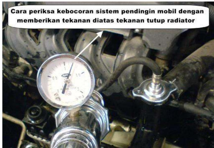
Periksa kebocoran cooling sistem dengan radiator tester
