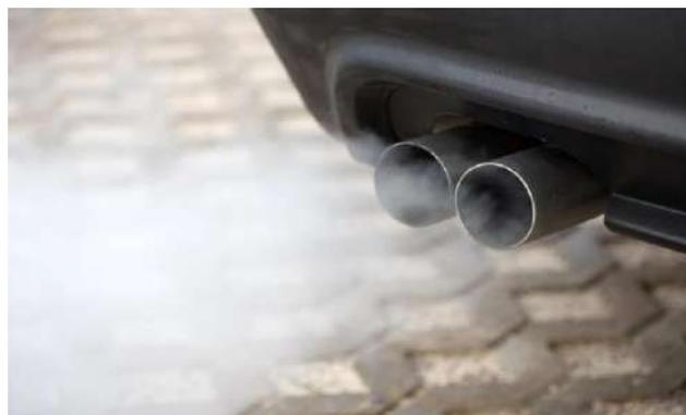
Asap knalpot yang berwarna putih pekat bisa sebagai indikasi cairan coolant atau oli transmisi otomatis masuk dan ikut terbakar di dalam silinder mesin.
