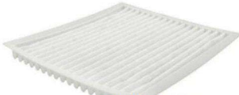
Filter atau saringan udara yang terbuat dari bahan kain, pembersihan filter udara ini sama dengan filter udara yang berbahan busa. Filter udara dari bahan ini dapat dibersihkan dengan air dan deterjen atau menggunakan cairan pembersih lainnya. Setelah bersih, lalu keringkan filter udara menggunakan udara bertekanan.
