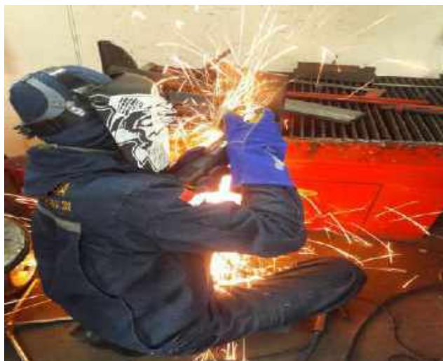
Gambar 3.5.1. Pembersihan Slag (Kotoran) Dengan Gerinda Tangan
