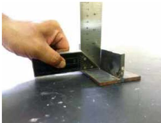
Gambar 2. 35 Mengecek Kesikuan Pipa dengan Pelat
