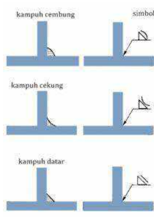
Gambar. 2.39 simbol kampuh sambungan fillet ( T )
