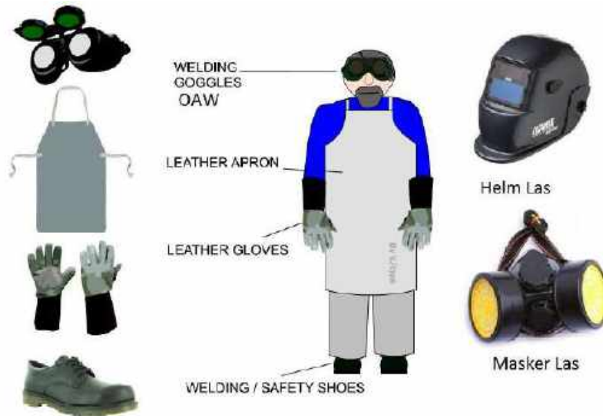
Gambar 2.1. Alat keselamatan kerja Las
